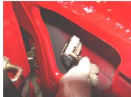
3.19、用 10#套筒拆下滑门上、中、下三处滑轮固定螺栓，取下滑门。
