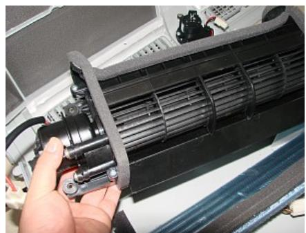
2.16、用十字起子拧下三个固定电机的螺丝，并撬下两个卡子。
