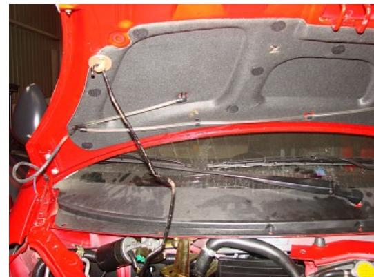
2. 用 13#扳手分别拆下电源负极的两个搭铁线（如图所示）。
