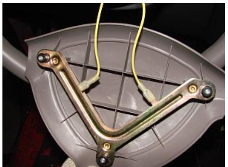
12、用 22#扳手拆下方向盘上的一颗螺栓，然后取出方向盘。
