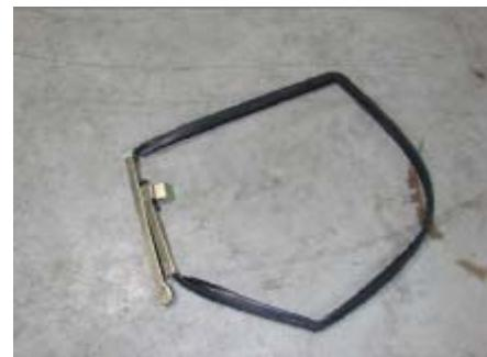
3.29、拆开门锁拉手拉杆。
