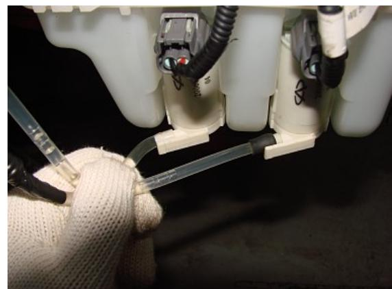
5、拔下与发动机线束对接的插件。
