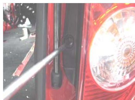
6.2、给后尾灯施加一个平行向前的力，使两个定位销脱离销孔。
