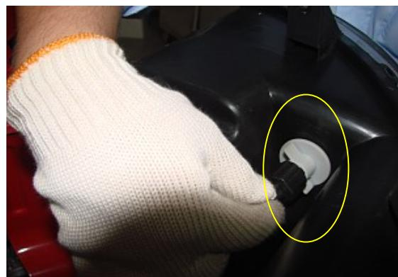
3、用 10#扳手拆下在左前舱附近的两根搭铁线。
