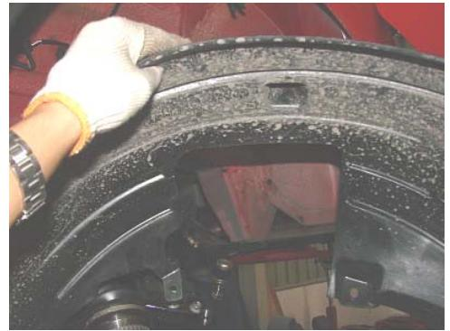
3.5、用同样的方法拆下右边的挡泥板。
