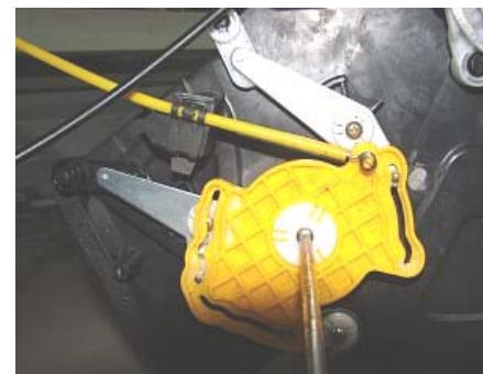
7.1.2、拆下控制盘后方的 3 个控制除霜、吹头、吹脚，控制臂的螺钉和垫片。
