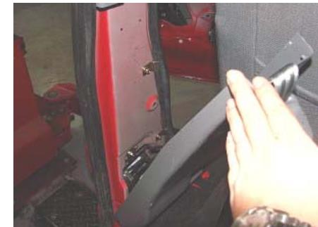
3.13、用 8#、17#套筒扳手拆下安全带锁止器，
