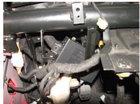
30、用剪刀剪断仪表板线束固定在仪表台横梁上的所有扎带。
