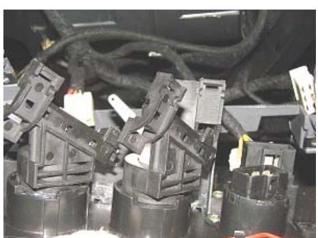
11、打开方向盘中间的喇叭按钮盖子，然后拔下其上的两个插件。
