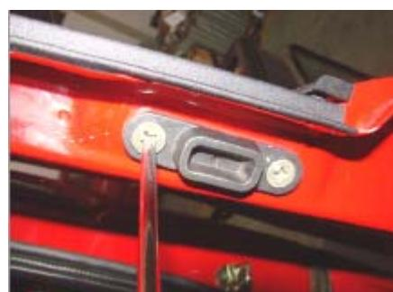
3.18、用 8#套筒拆下滑门门锁锁体的 3 个固定螺栓，取出锁体。
