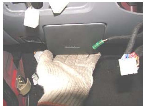
20、用十字螺丝刀拆下其上面的螺钉。
