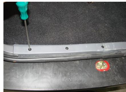
1.3、拆下 A 柱下内护板。
