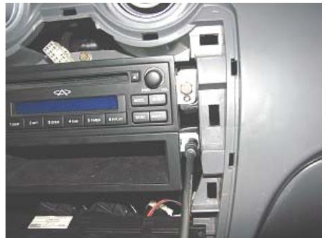
8、拔下天线插头和音响插件插头，取下收音机。
