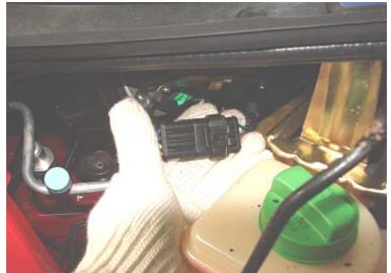
10.拔下与空调压力开关连接的插头。
