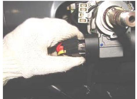
17、从夜光开关面板后顶出夜光开关面板，然后拔下其上的两个线束插头。
