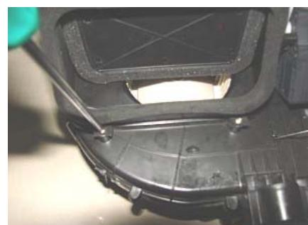
9.1.3、拆下内外循环风门电机的 3 条螺钉，
