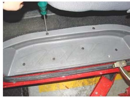
3.5、拆下后门洞密封条。
