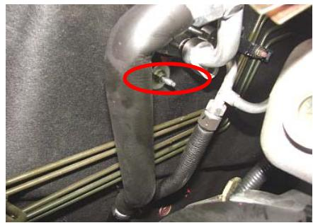
2.6、用鲤鱼钳将蒸发水箱的进出水管卡环拆下，拔下水管。
