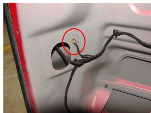
13、用十字起拆下左后扬声器的螺钉并拔下插件。
