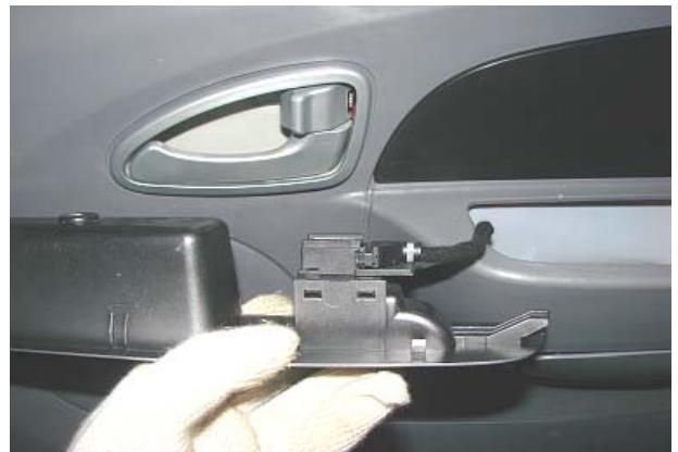
2、用10#扳手拆下右前门线束上的搭铁线。
