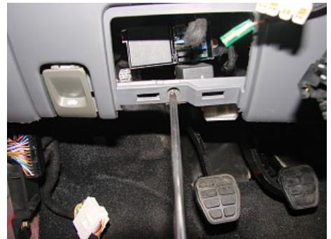
21、用十字螺丝刀拆下前仓盖锁拉线开关上的一个螺钉，掰开这块护板然后从拉线开关后面旋下与其连接的塑料螺栓。取下拉线开关和护板。
