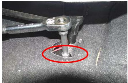
3.2、用手向上拨固定座位的卡子，拆下座椅。
