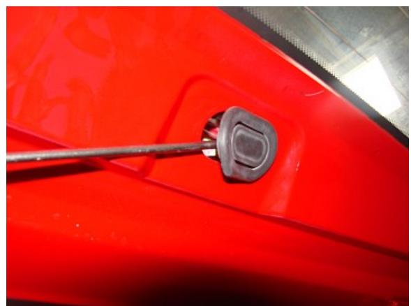
3、拔下高位制动灯处洗涤液软管接头.
