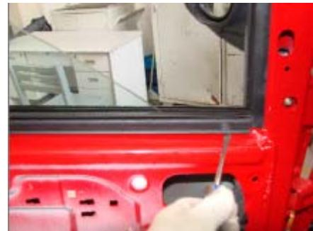
3.20、用十起拆下玻璃外挡水条固定螺钉。
