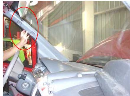
6.1.2、请用十字起拆下顶置蒸发器的护板。
