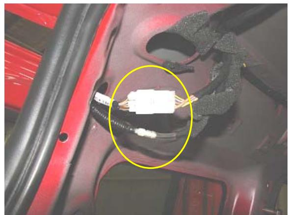
2、用螺丝刀撬开高位制动灯处的护盖,然后拿出高位制动灯插件并将其拔下。
