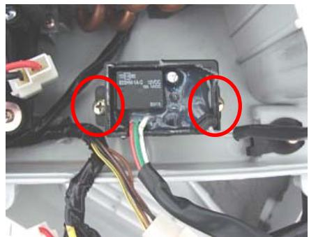
2.9、拆下蒸发器温度传感器总成。
