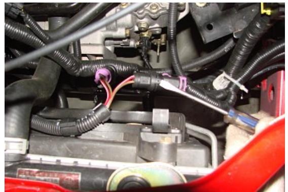
7.拆下前保险杠（拆卸方法请参见前保险杠和后保险杠的拆装部分），然后拆下与高音喇叭的插件。
