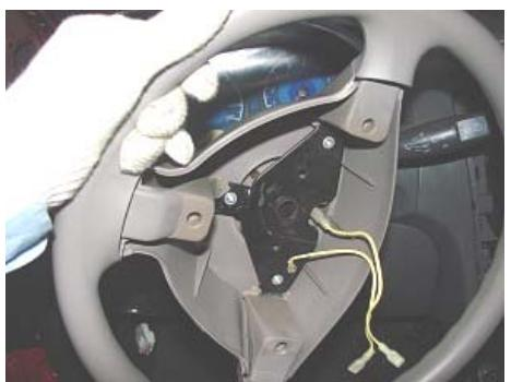
13、用十字螺丝刀拆下组合开关与点火开关连接的两个螺钉。
