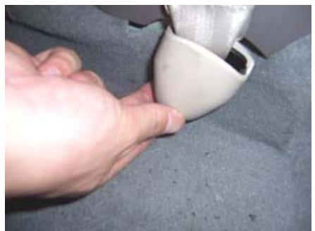
3.8、用平口起子撬下安全带调整器上装饰盖。(注意：小心里面的卡子断裂)
