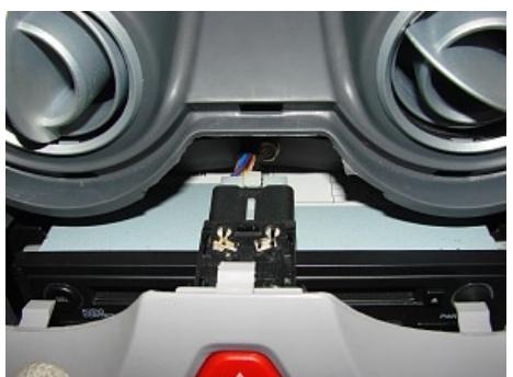
6、用十字螺丝刀拆下空调控制开关与仪表台本体连接的 4 个螺钉，然后将其拉出一定距离，留出拆音响螺栓的空间。
