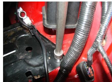
8、拆下电喷线束与 ECU 线束的插件。
