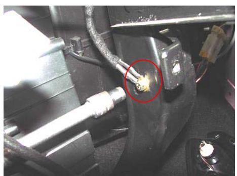
29、用 10#扳手拆下防盗控制器上的两颗螺栓并取下。
