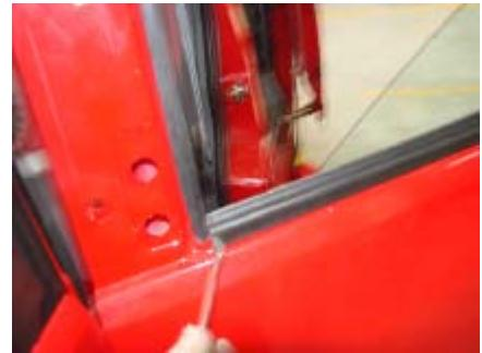
3.22、拆下固定门窗玻璃的两条螺钉。
