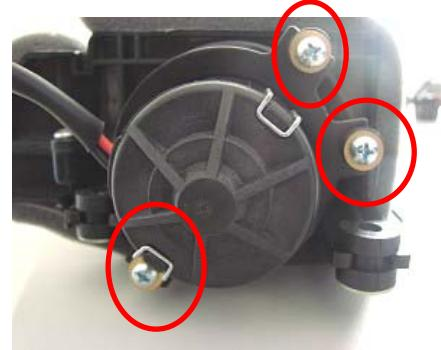
2.17、对准风扇工艺孔，用一字起子拧下电机传动轴定位销。
