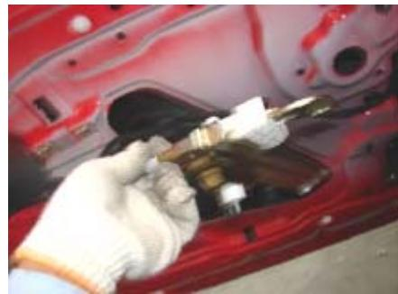
3.26、用 10#套筒拆下门窗玻璃导轨的两个固定螺栓。
