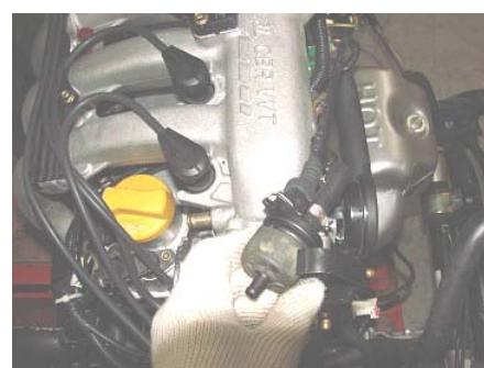
20、拆下进气岐管压力传感器插件。
