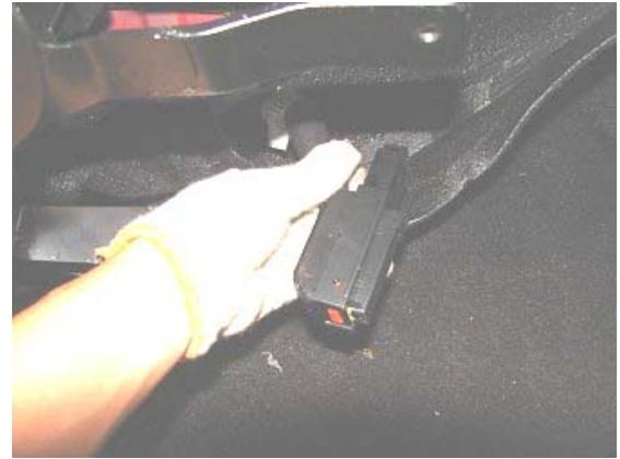
13.用 10#扳手拆下 ECU 处的两个搭铁线。
