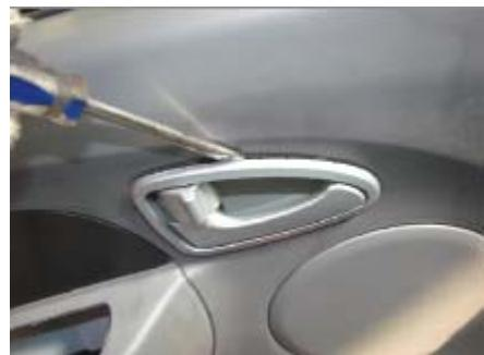
3.6、用十字起子拆下前门护板下部固定螺钉。
