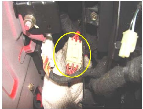
8、请拔下接顶棚线束的插件。
