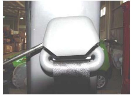
3.9、用 17#套筒拧下上方固定螺母，取下安全带。
