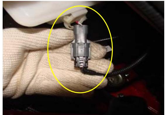
9.拆下雨刮电机插件。拆卸方法请参照风扇高速插件的拆卸方法进行。
