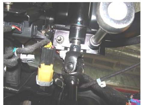
32、用 13#扳手拆下仪表台横梁与车身连接的六颗螺栓，之后取下仪表台横梁。
