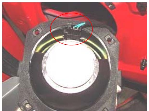
6、拔下与右前门中控锁连接的插件。
