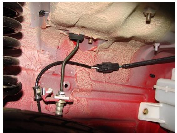
16.拔下前舱与仪表板线束中的洗涤软管接头。
