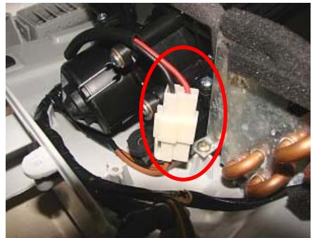
2.15、拆下电机及风扇总成。
