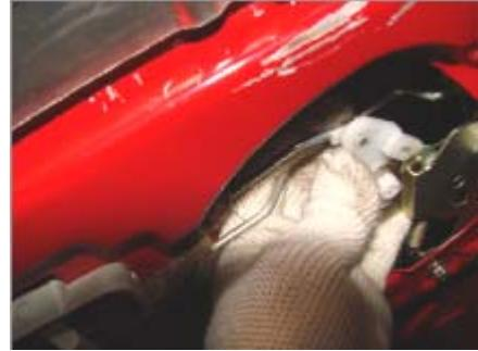
3.9、用十字起拆下滑门门锁开关固定螺钉。
