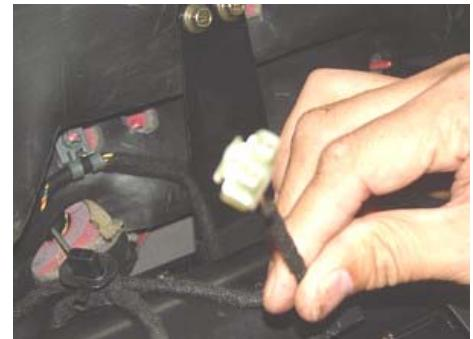
15、拔下与安全气囊的插件，并用10#扳手拆下该处螺栓。
