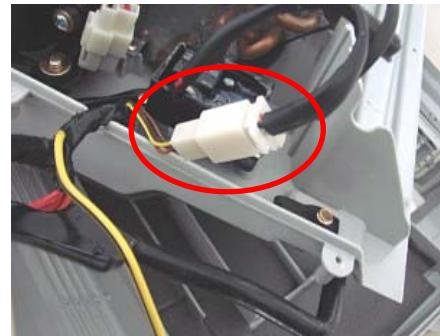
2.8、拧下蒸发器温度开关的固定两个螺丝。
