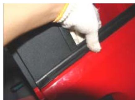
3.17、用十字起拆下滑门缓冲垫固定螺钉，取下滑门缓冲垫（两个）。
