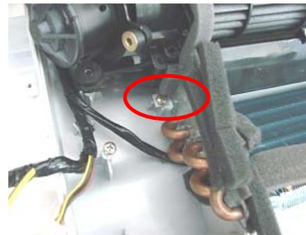
2.20、拆下蒸发器总成。
