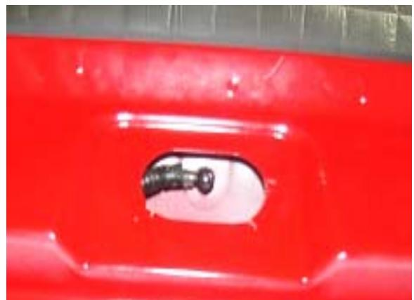
4、拆下后备门内护板，拔下与后除霜器正极的插件。
