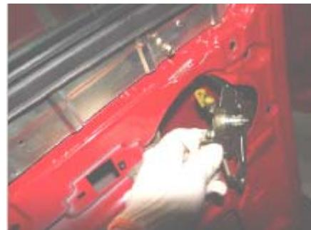
3.15、用十字起拆下滑门外防水胶条固定螺钉。
