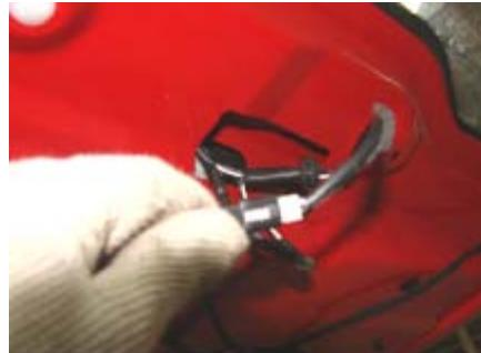
7.1.3、用 8#套筒扳手拆下牌照灯的两个固定螺母。
