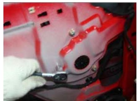
3.24、拆下玻璃升降器导轨的两个固定螺母。
