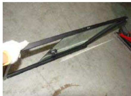
3.8、拔开滑门门锁开关拉杆。
