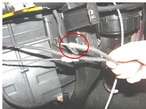
3、拔下接前仓洗涤水管的插头。
