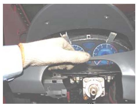
23、用十字螺丝刀拆下仪表上的三个螺钉。取出仪表时拔下其上的插头。
