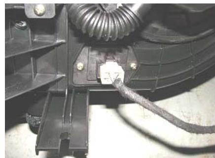
5.1.2、用十字起子拧下调速模块上的两个固定螺钉。
