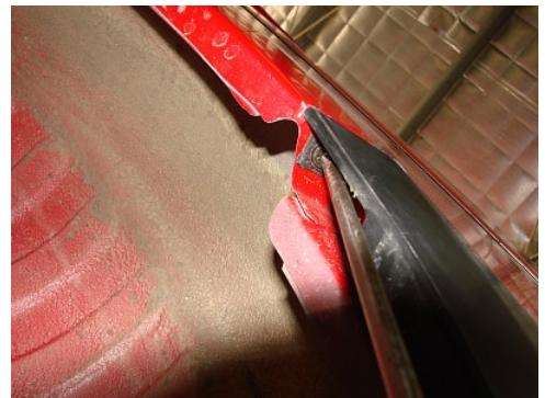
3.3、用十字螺丝刀拆下底盘与后保险杠最下面的三个螺钉。
