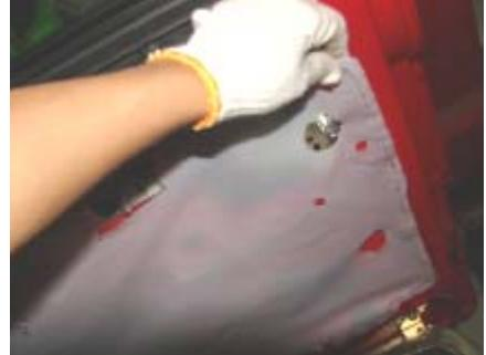
3.8、用 8#套筒拆下滑门玻璃框的 4 个固定螺栓。
