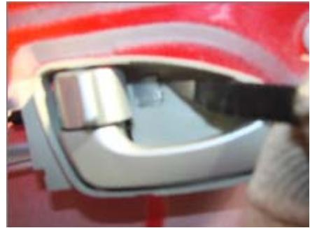
3.15、用十字起拆下前门内拉手处固定螺钉。
