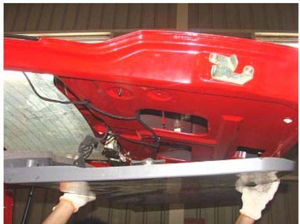
2、用 10#扳手拆下除霜线束上的搭铁线。
