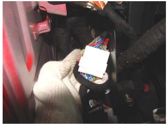
7、用 10#扳手拆下左前门线束搭铁线。
