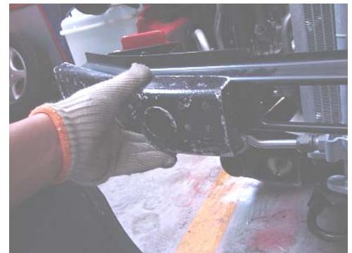
3.11、用 10#套筒拆下金属保险杠上的四颗螺栓，然后取出金属保险杠。
