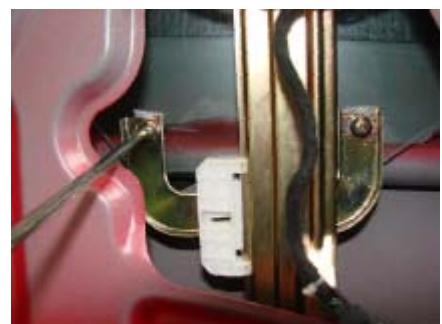
3.23、拆下玻璃升降器电机的三个固定螺母。
