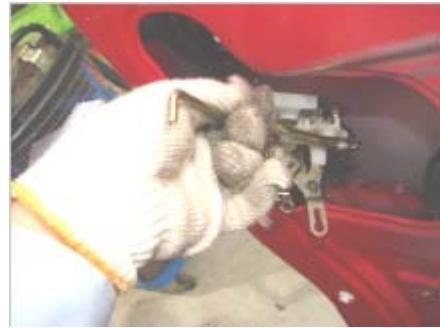
3.32、用 10#套筒拆下门拉手的两个固定螺栓，
