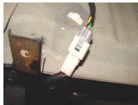
7.3、用十字起子拧下固定后雾灯及倒挡灯的螺丝。
