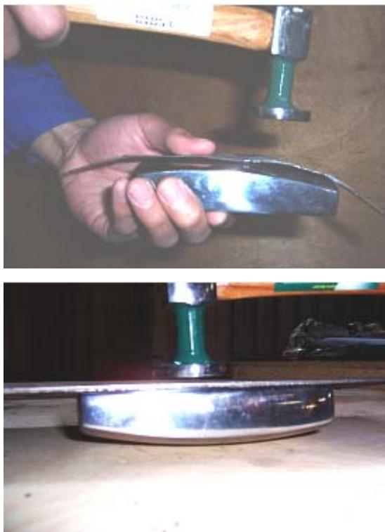
② 手锤不在垫铁上方敲击。这种锤击方法是将垫铁托于金属板凹陷最低处的下面，用手锤敲击附近的高处。
