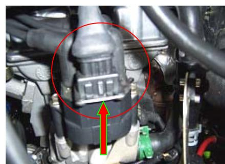
18、拆下与电子节气门的插件。
