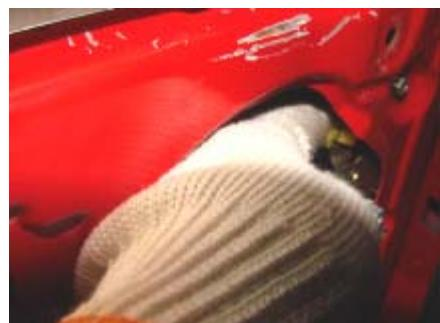
3.12、用 8#套筒拆下滑门门锁的三个固定螺栓。
