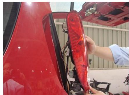
6.3、拔下后尾灯插头，拆下后尾灯。
