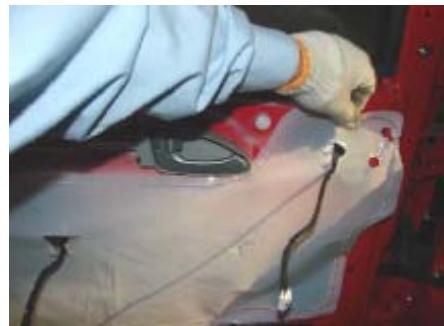
3.11、拔下前门锁开关的拉线。
