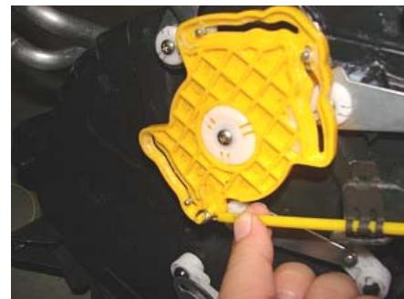
6.1.6、拆下冷暖控制风门拉杆。
