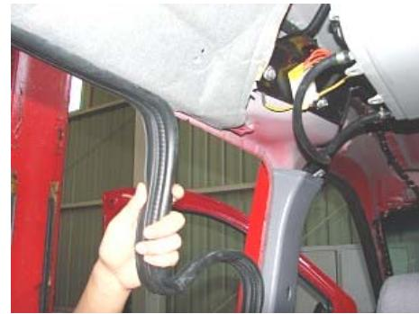
9.1.5 打开后备箱，拆下顶棚（从后备门内取出方便也不宜损坏顶棚）。
