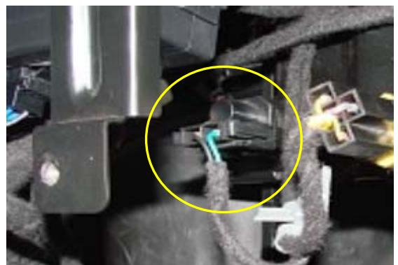
23.拔下与制动踏板开关的插件（该插件位于制动踏板上方）。
