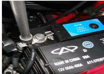
2、拆下蓄电池的正极，取下蓄电池总成。
