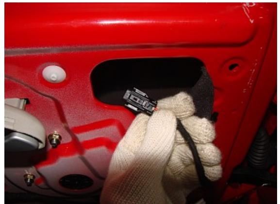
4、用十字螺丝刀分别拆下扬声器与车门上的四个螺钉，拿出扬声器并拔下其上的插件。
