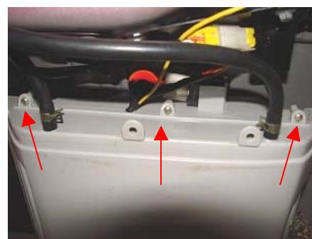
2.2、用十字起子拧下蒸发箱背面的八个固定螺丝。
