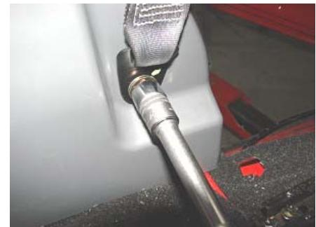
3.11、用平口起子撬下 B 柱内护板。
