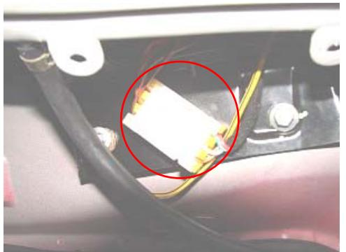
6、拔下与后背门洗涤水管的接头，并拔下与后背门线束的对接口插件。
