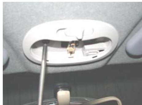
5.1.3、请拔下线束插件，取下前顶灯总成。
