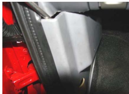
1.4、拆下 B 柱下内护板。
