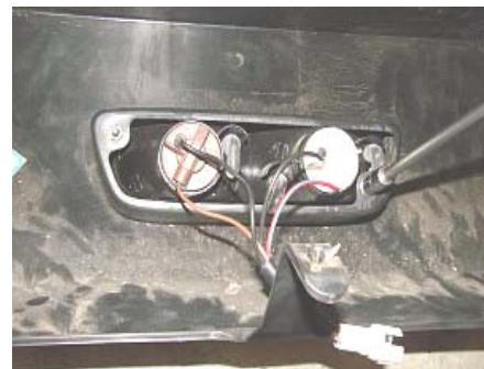
7.4、拆下后雾灯及倒档灯总成。
