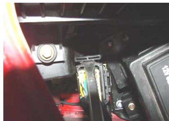
6、拆下空气滤清器，拔下与风扇电机连接的接头。
