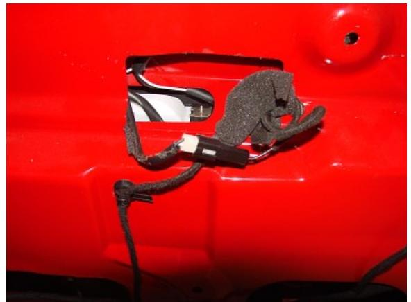
6、用 10#扳手拆下后备门线束搭铁线。
