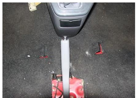
2.2、将地毯沿车底形状铺设，并将座椅安装孔露出，铺实。
