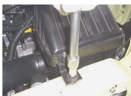
4、用 10#扳手拆下空气滤清器进气口的固定螺母。
