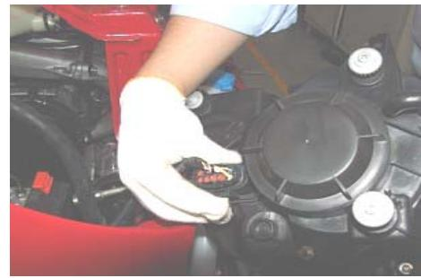
3.5、拔下转向灯插头，取下前大灯及转向灯总成。
