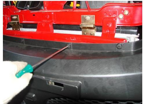
3.8、用 10#扳手拆下保险杠与翼子板上的螺栓。
