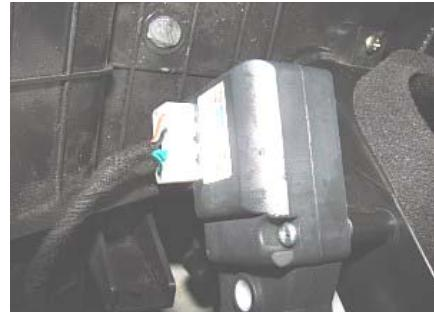
9.1.2、拧下 4 个固定螺丝，拆下壳体。
