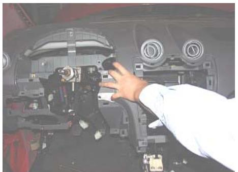
28、用 10#扳手拆下仪表台横梁上的两根搭铁线。
