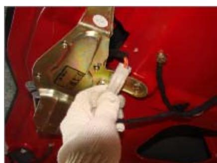
6.1.7、用 8#套筒扳手拆下后雨刮电机上的 3 条固定螺栓。
