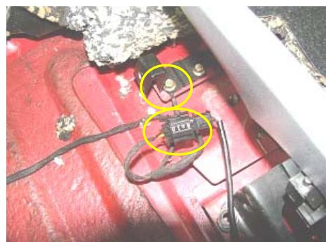
4、用十字起拆下左前门门控开关
