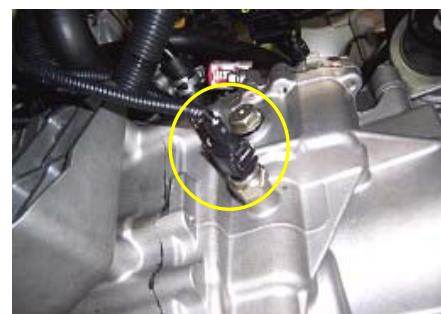
10、拆下起动机的正极线和负极接头。
