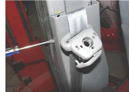
3.12、拆下 B 柱内护板。
