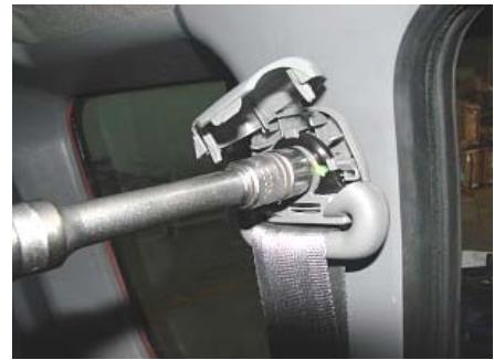
3.10、用 17#套筒拧下下方固定螺母，取下安全带。
