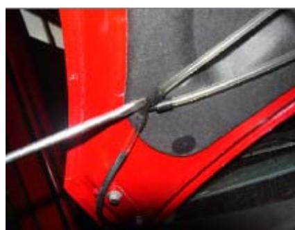
3.1.4、从前仓盖下方压下两个喷水嘴的卡子，将喷水嘴从前仓盖下方推动，从外侧取下喷水嘴。
