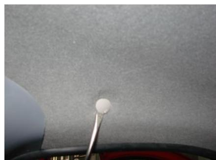
6.1.4 请用手拆下前排车顶护板。
