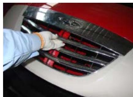
5.3、用十字起拆下固定进气格栅的 4 个固定螺钉，
