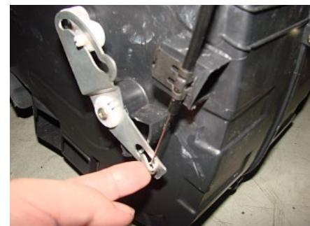
6.1.7、拆下暖风箱壳体上的 8 个螺丝，
