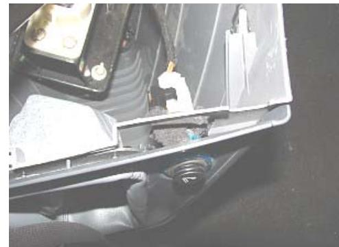
23、用 10#板手拆下仪表中控台处的搭铁螺栓。
