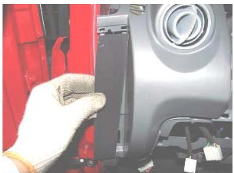
25、拆去 A 柱护板那一段门洞封条，拆下 A 柱护板（左右各一个）。然后用 10#扳手拆下仪表台连接的所有螺栓。
