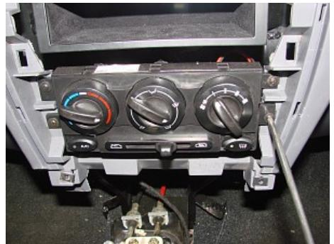
7、用 8#扳手拆下音响与仪表台本体连接的 4 颗螺栓。
