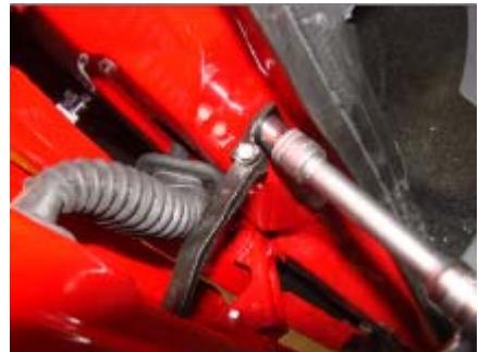
3.41、用 13#套筒拆下左前门两个铰链的 4 个固定螺栓，取下左前门。
