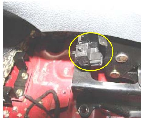
7、用十字起拆下左滑门接触开关并拔下插件。
