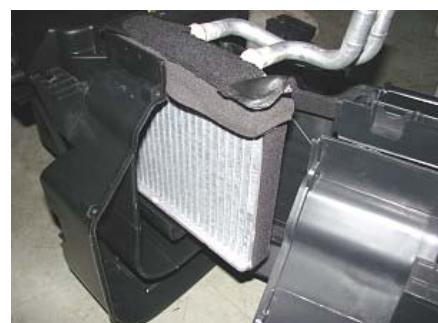
6.1.8、用一字起子撬下固定冷暖风盖板总成的锁扣。
