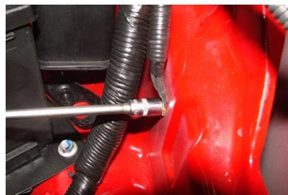
4、拔下与洗涤液灌连接的线束接头。
