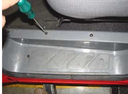
3.2、拆下前门洞密封条。
