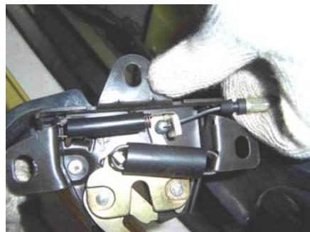
7.1.2、拆下空滤，将固定拉线的卡子拆下。
