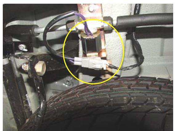
18.用 10#扳手拆下右前纵梁处的搭铁线。
