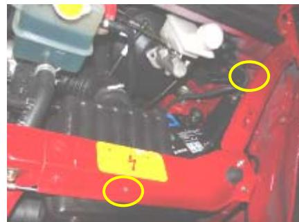
7.1.3、用十字起拆下前仓盖打开拉手处的固定螺钉。
