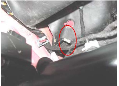
4、拆下顶棚（请参照顶棚的拆装），拔下与前后顶灯的插件。
